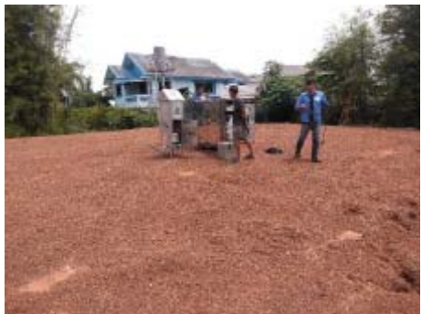
ติดตั้งเครื่องตรวจวัดเสียง ลม อากาศ เพื่อติดตามผลกระทบสิ่งแวดล้อมจากโรงไฟฟ้าในพื้นที่ชุมชน
